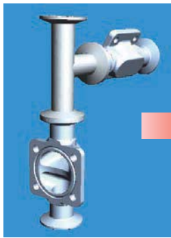
2方弁2台をサニタリー管で接続
